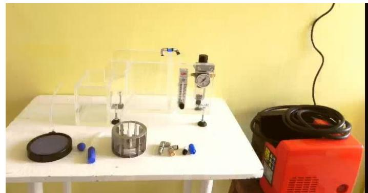
Stand experimental pentru studiul procesului de separare din amestecuri multifazice. a unor substante insolubile in apa, a unor particule coloidale, greu de separat, in urma formarii unor agregate bula de gaz-solid. Standul este compus din:
